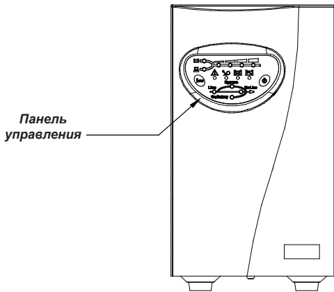
Рис. 2-1.1 Передняя панель ИБП мощностью 1 кВА
